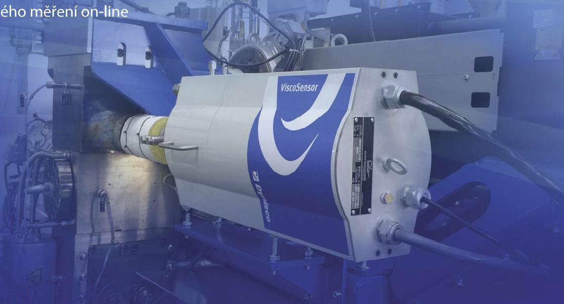
On-line reometr protlačuje materiál skrz kapiláru daného průměru a dochází ke generaci tlaku napříč kapilárou. Snímáním rychlosti smykové deformace materiálu při protlačování materiálu skrz kapiláru nebo smykového napětí napříč kapilárou je vypočtena zdánlivá viskozita popřípadě index toku taveniny. ViscoSensor využívá diferenciální tlak napříč kapilárami buď jako kontrolní bod měření indexu toku nebo jako měřící bod pro výpočet zdánlivé viskozity.
