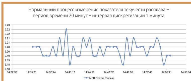
На приведенном выше графике показаны параметры процесса, измеренные ViscoSensor во время обработки сравнительно густого материала. Соответствующее значение показателя текучести расплава (MFR) показывает, что материал является гомогенным, а молекулярный вес стабильным, из чего следует, что ветвление полимерной цепи остается постоянным.
