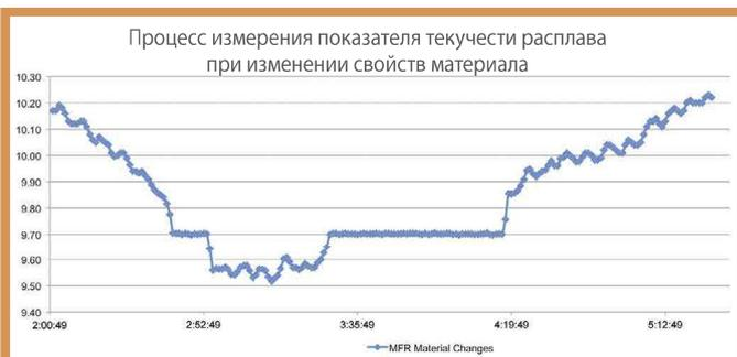
На приведенном выше графике показаны параметры процесса, измеренные ViscoSensor во время обработки расплава. Исходный материал претерпел фундаментальные изменения или в процессе возникли локальные изменения. Например, расплав может быть результатом изменения молекулярного веса/побочных переходов или подмешивания другого сорта материала. Метрика процесса восстанавливается путем устранения причины изменения, измеренного ViscoSensor.
