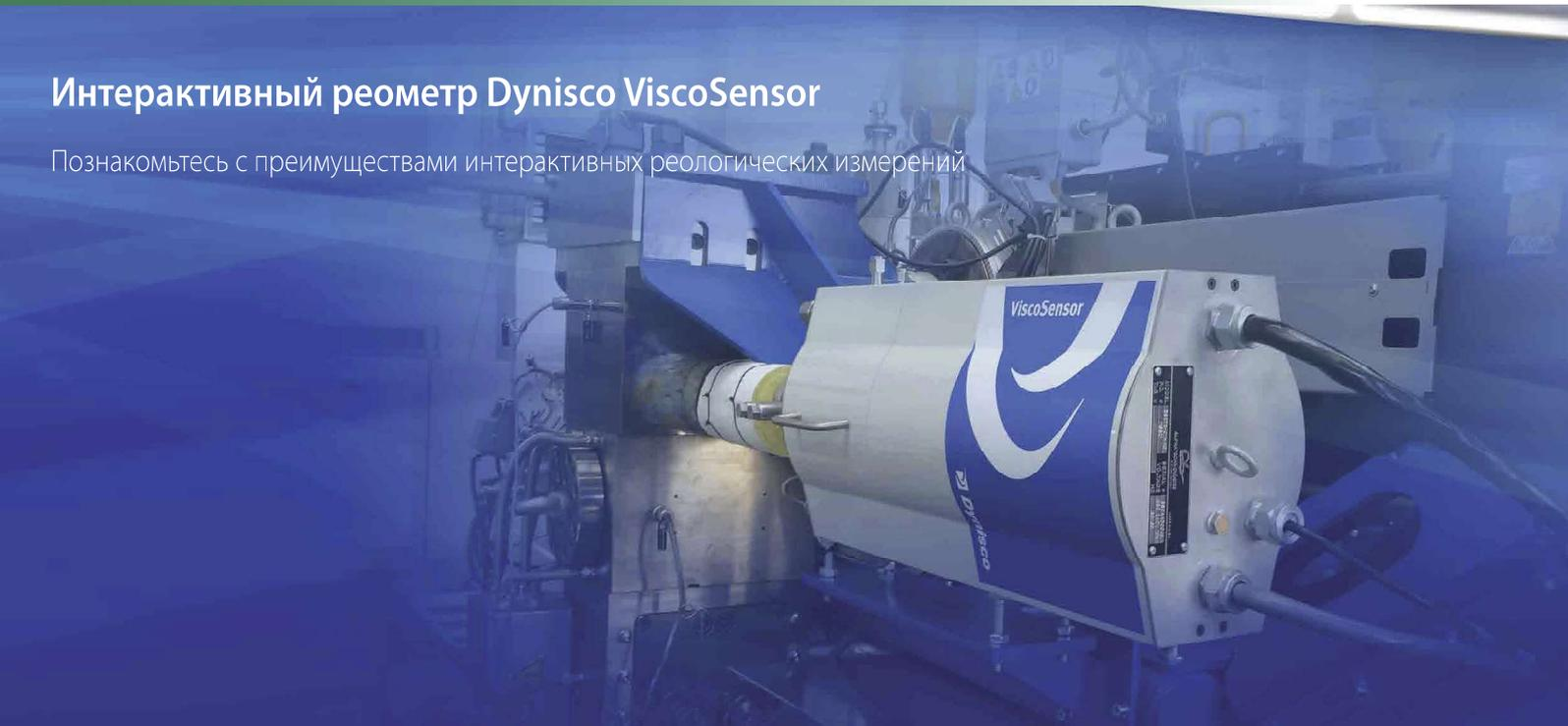
Капиллярный реометр проталкивает материал через капиллярную фильеру небольшого диаметра, создавая в ней падение давления. При регулировке скорости сдвига материала в фильере в продольном направлении или сдвиговых напряжений в поперечном направлении определяется вязкость или индекс текучести расплава. ViscoSensor использует перепад давления в капиллярной фильере либо для контрольной точки для измерения индекса текучести расплава, либо в качестве точки измерения для расчета эффективной вязкости.
