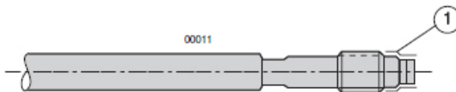
Obrázek 08 : Zkušební šroub s tuširovací barvou
